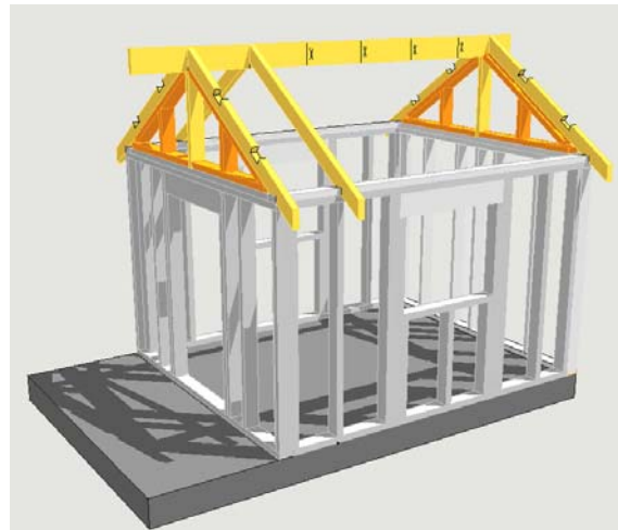
Common rafter 설치
