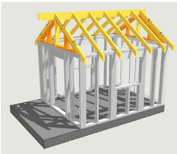
Common rafter 설치
