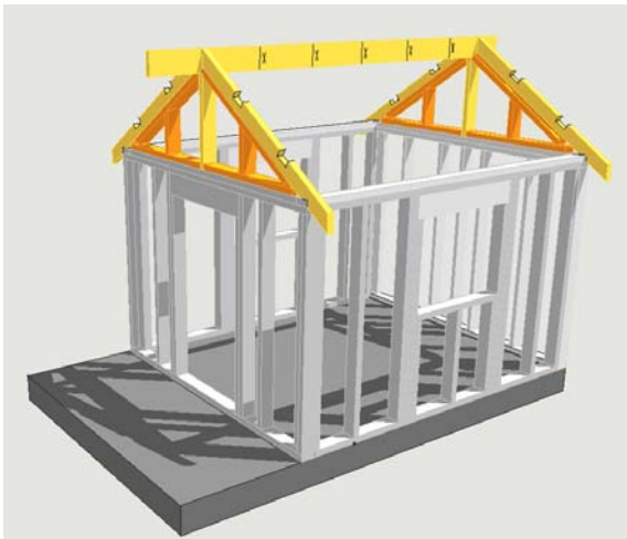
Gable wall stud & blocking 설치
